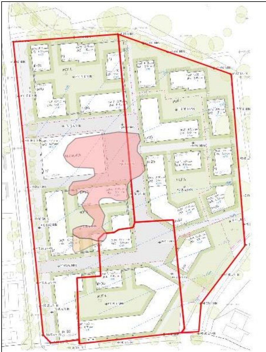
Abbildung 6: Zu sanierende Kontaminationsfläche und ihre Ausdehnung
