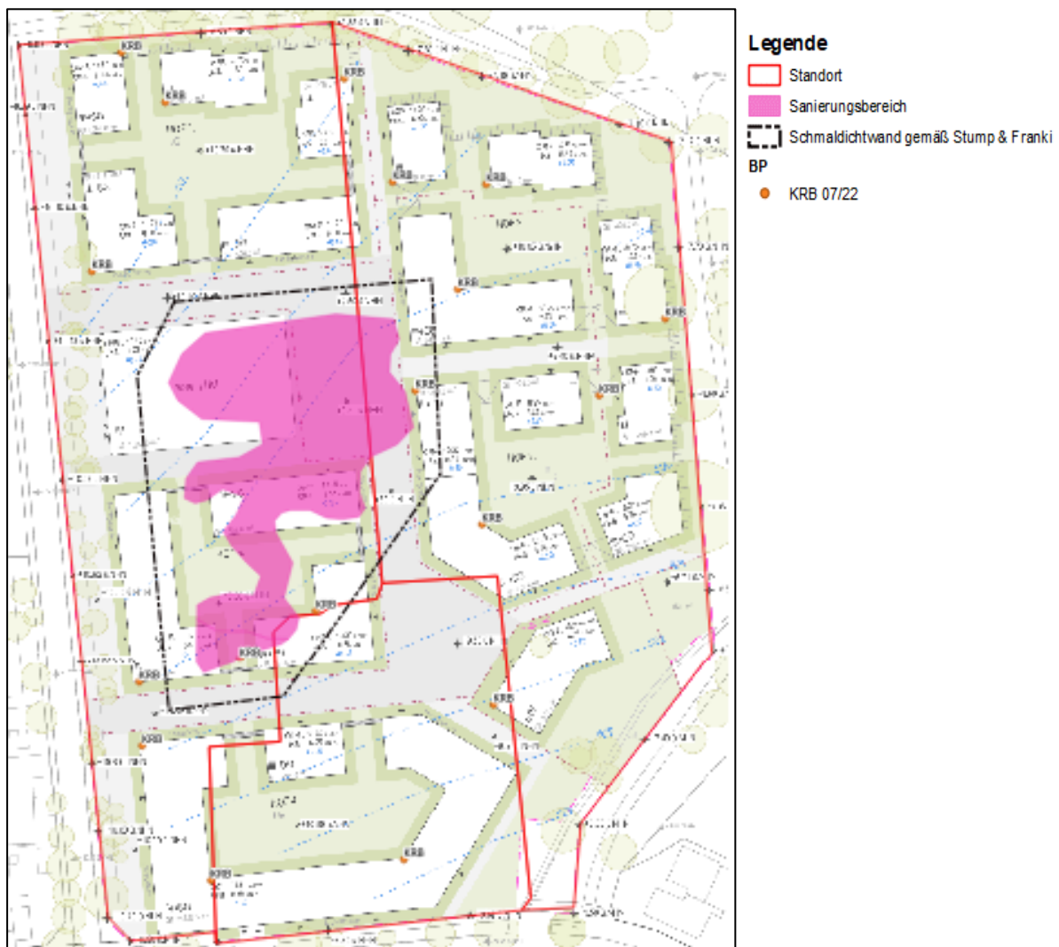
Abbildung 4: Lageskizze zur Schmaldichtwand (schwarz gestrichelt)
